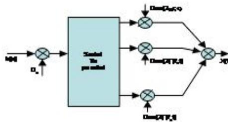
Fig. 1 MC-CDMA Transmitter
