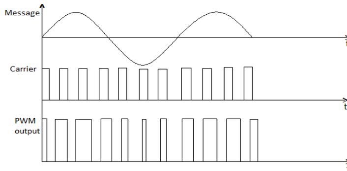
Figure 6 : PWM Waveform Generation
